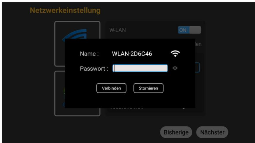
Mit der Virtuellen Tastatur, den Pfeiltasten auf der Fernbedienung und der Entertaste wird nun das Passwort eingegeben. Mit dem „Grünen Winkel“ wird die Eingabe an die W-LAN Zeile übergeben und dann mit Verbinden wird der Zugang am Router freigeschaltet.
