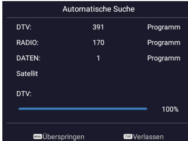
Nach einem Scan wird dann das erste Programm der Liste angezeigt. Wenn noch kein CI-Modul eingesteckt ist, wird dies im Bildschirm als Gesperrt angezeigt.
