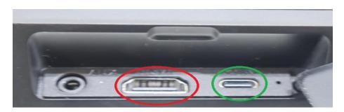
Die Soundbar ist, von hinten, mit zwei Steckern angeschlossen HDMI (rot markiert) und USB C (grün markiert).
